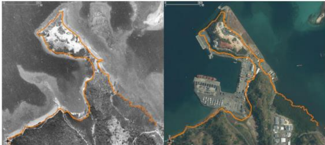
Figure 8 : Photographies aériennes de la Pointe de Longoni (BD Ortho historique 1950 à gauche – BD Ortho HR 2016 IGN à droite, Trait de côte Histolitt® de 1950 en orange). (Source : CEREMA, 2019)
